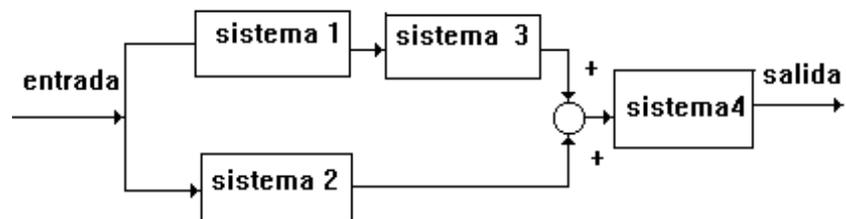
Figura 5.- Interconexin serie-paralelo
