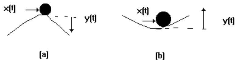
Figura 7. Sistemas BIBO Inestable (a) y estable (b)
