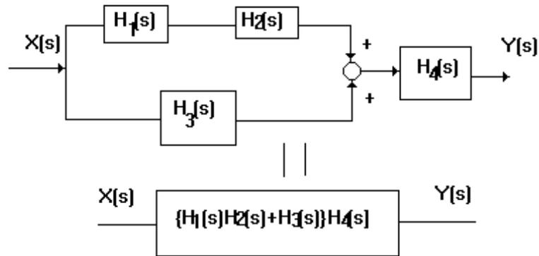
Figura 17.-Conexin serie paralelo
