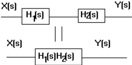
Conexin cascada de funciones de transferencia
